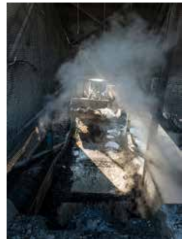
För att minska verkets vattenförbrukning har havsvatten ersatt dricksvatten vid kylning av slagg.
