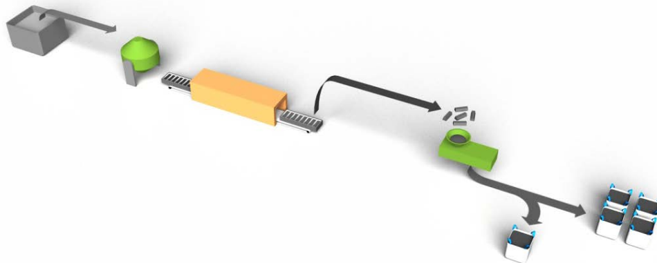
Figur 3 Tillverkning av mangansulfid genom dosering, blandning, reaktion, krossning, malning, siktning och utpackning.
