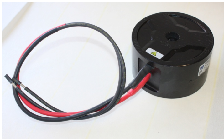
Figur 2 Induktor för användning i solenergisystem, tillverkad av ytbelagda mjukmagnetiska pulver från Höganäs. Komponenter till induktorerna är tillverkade av Höganäs, men i detta fall med slutmonterade hos externt företag.
