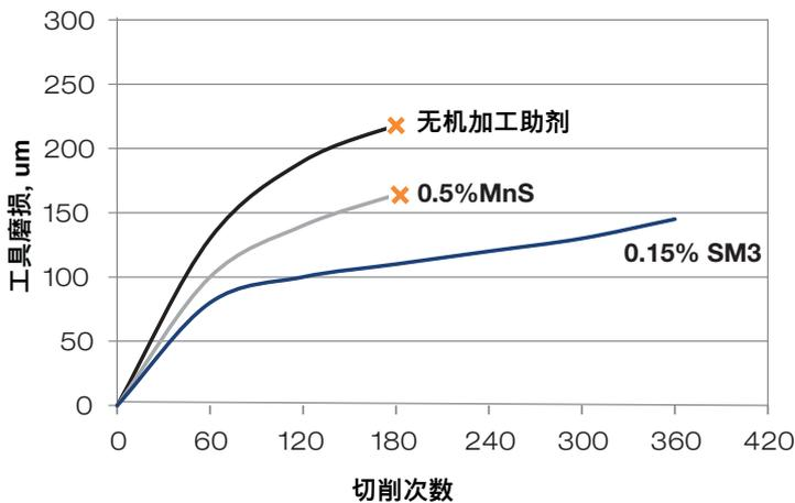
混粉中添加机加工助剂后实际使用效果。
