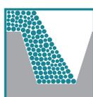
流動性及び充填性の改善により、部品内の密度分布がより均一化されます。この結果、成形体の重量及び高さ寸法バラツキを最小に出来、寸法制御が改善される事で不良率を低減出来ます。
