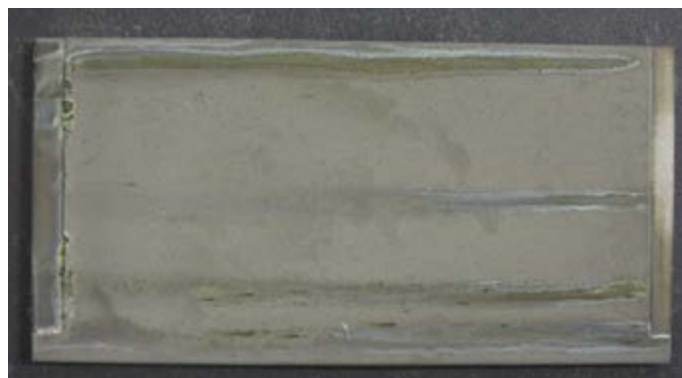
Amperit 678在NSS盐雾测试 1008小时后的腐蚀样品
