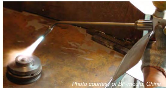
Figura 19 Finas camadas minimizarão a oxidação
