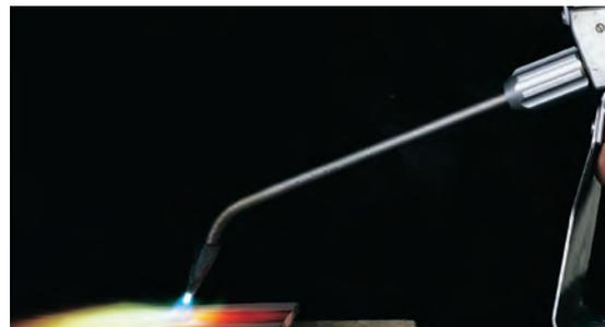
Figura 20 Manutenção de uma poça de fusão
