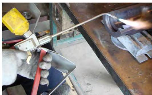
Figura 16 Soldagem a pó das bordas do molde
