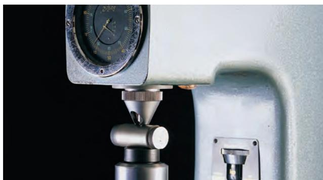
Figura 11 Medição de dureza
