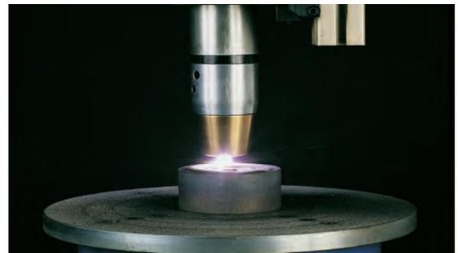
Figura 31 Processo de deposição por PTA
