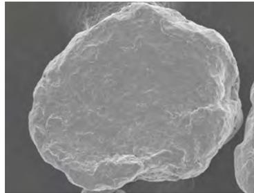
较粗的颗粒尺寸及平滑表面促进焊条生产量。
